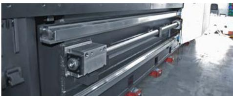
nötige Stabilität. Auf beiden Seiten wird das Portal auf zwei Linearführungen bewegt. Dabei wird es von robusten Kugelspindeln angetrieben.
