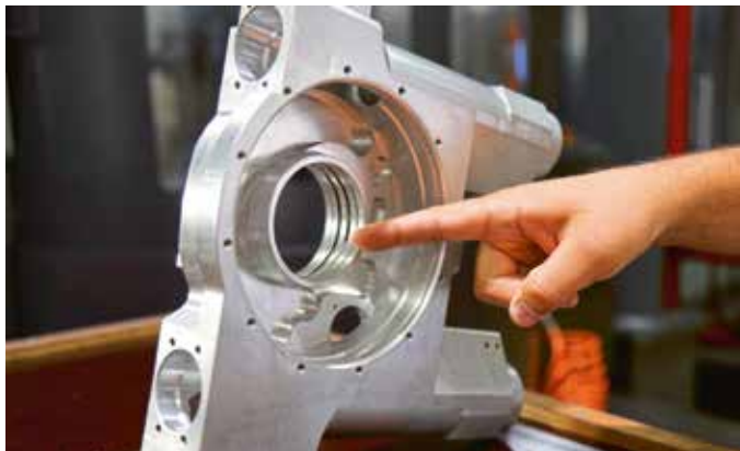
Typisches Bauteil, das auf den OKK-Zentren per Turm-Mehrfachspannung mannlos zerspannt wird.
