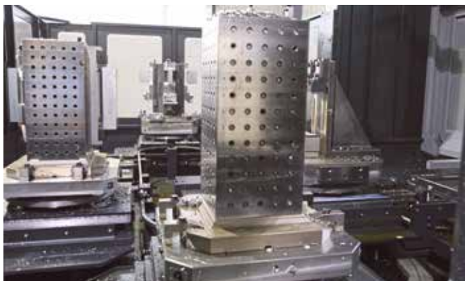
Blick in den 6-fach-Palettenbahnhof der OKK 630. Die OKK-Horizontal-Bearbeitungszentren sind ideal für Spanntürme geeignet. Der Palettenbahnhof ist eine OKK-Eigenentwicklung.
